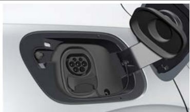
Charging socket Type 2 AV (e.g. in the EU)
